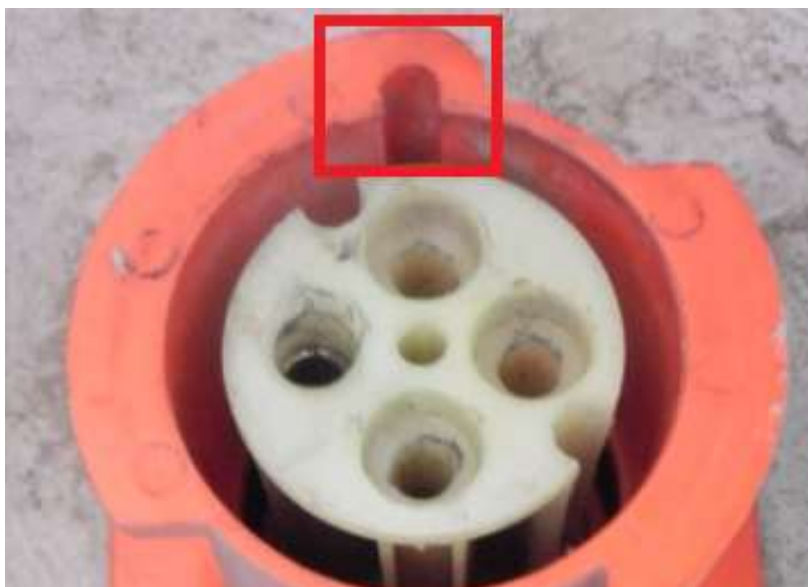
Encaixe do pino guia na tomada
